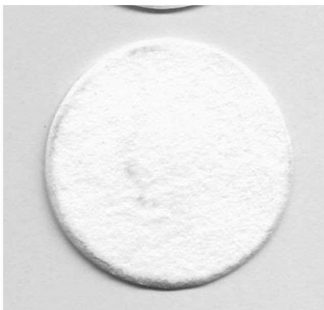
شکل شماره ۳: نمونه ای از پدهایی که هولدر حاوی آنها در فاصله نزدیک به قوس جوشکاری قرار گرفته بودند. (به ناحیه سیاه وسط فیلتر توجه شود)
