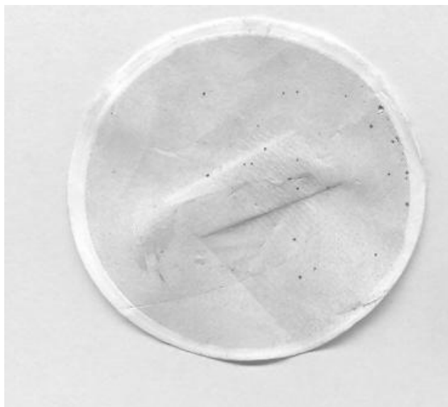
شکل شماره ۲: نمونه ای از فیلتر هایی که در در فاصله نزدیک به قوس جوشکاری قرار گرفته بودند. (به نقاط سیاه ریز روی فیلتر توجه شود)
