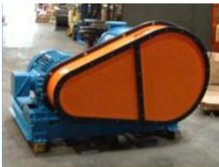
حفاظ گذاری تجهیزات انتقال نیرو
