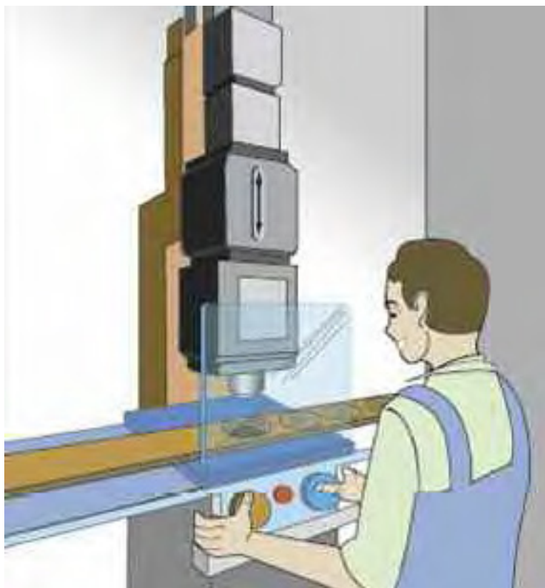
شکل ۲۳-۱: از کنترل‌های مهندسی مانند کلید کنترل دو شستی برای ماشین پرس خطرناک استفاده کنید، در این صورت کارگران در مواجهه با ریسک‌های مرتبط نخواهند بود.
