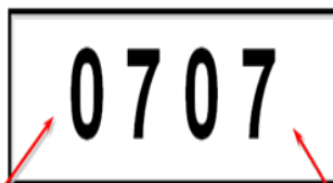
شکل ۱: تاریخ تولید حک شده بر روی تایر
